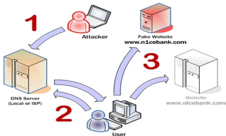
(Tấn công pharming thông qua tấn công vào máy chủ DNS)
